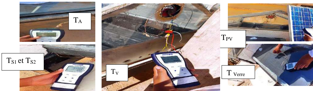
Figure. II.6 : Mesure de la température dans un capteur thermique
