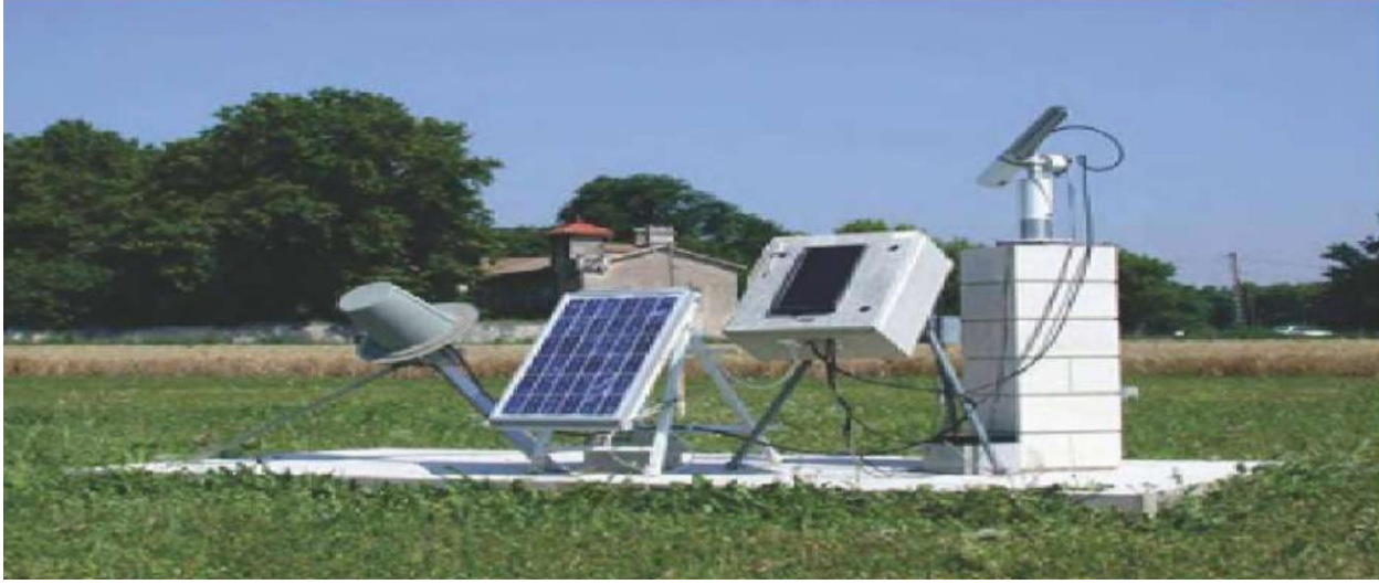
الشكل I-13 : أداة قياس الضوء الشمسي المستخدمة في شبكة AERONET.
