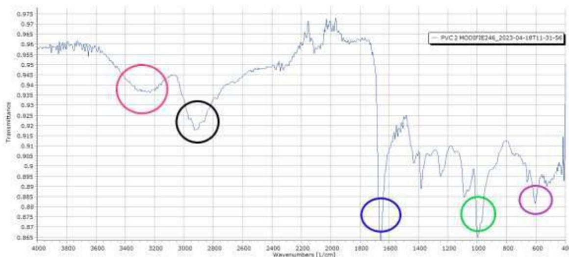
Figure IV.11 : Spectre IR de PVC<sub>2</sub>Tableau IV.03 : Principales bandes infrarouges caractéristiques du PVC<sub>2</sub>
