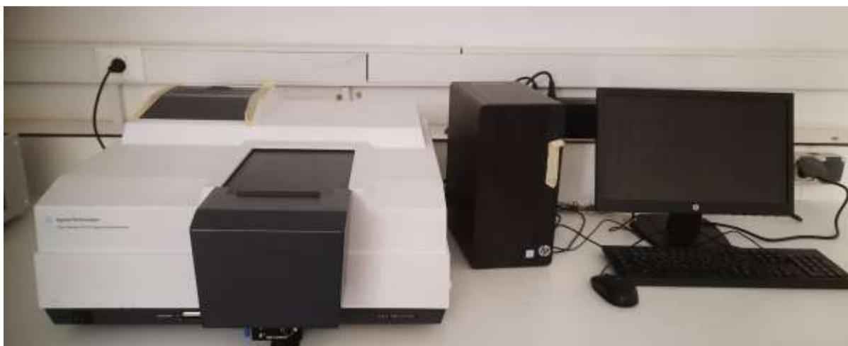
Figure II.02 : Spectrophotomètre d'absorption UV-VIS CARY 100 (Agilent Technologies)
