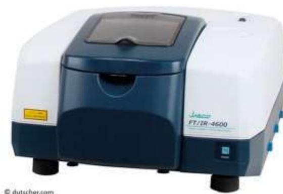
**Figure II.03 : Spectrophotomètre infrarouge IR FT/IR Jasco 4600**
