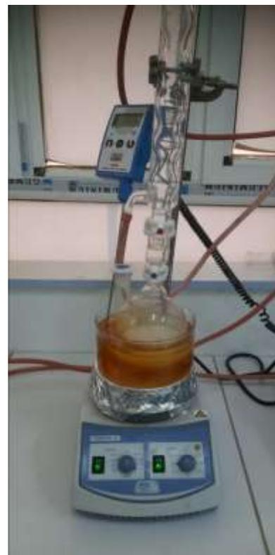
Figure III.06 : Le montage à reflux
