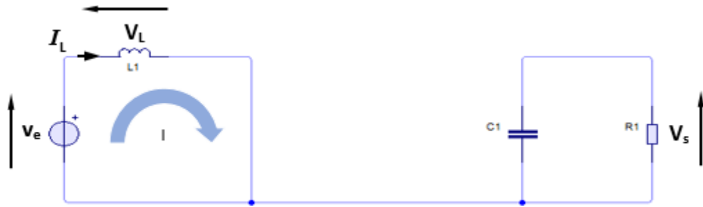
Figure I-12 Circuit équivalent du Boost quand l'interrupteur K est fermé
