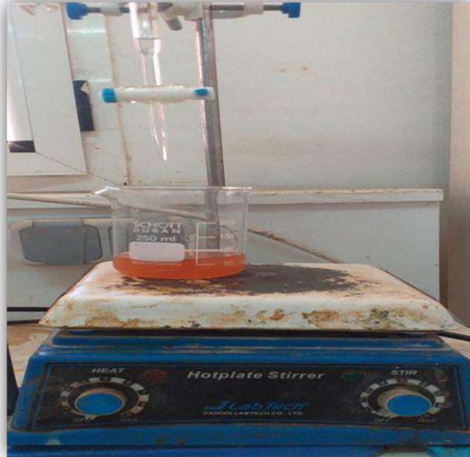
Photo 04 :Titrage pour la détermination de la DCO
