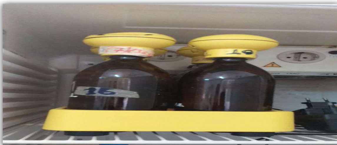
Photo 02 : la DBO mètre pour la détermination de la DBO
