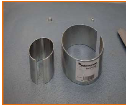
الشكل 12.2: أداة تساعد في وضع الحلقات المطاطية.
