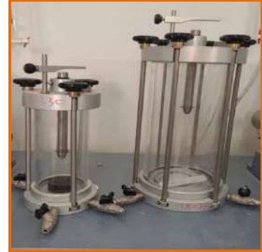
الشكل 1.2: خلايا القص ثلاثي المحاور (100مم، 50مم).
