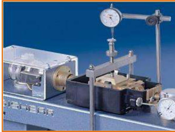
الشكل 3.1: علبة القص المباشر (المسمات كذلك علبة كازاقراند).
