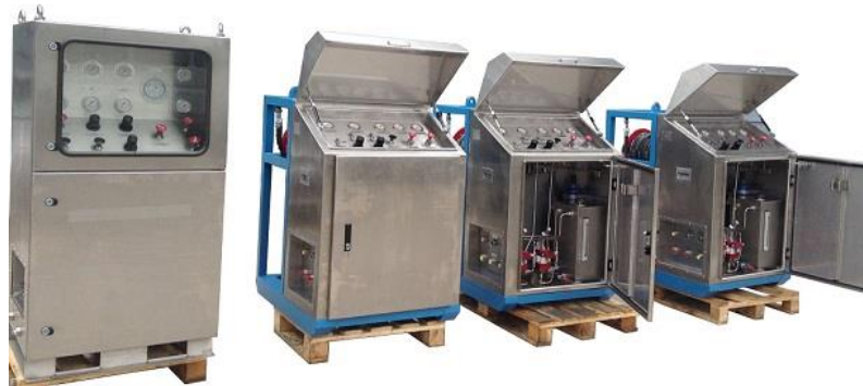
Figure I.12: Un système d'arrêt d'urgence (ESD : Emergency Shut Down)
