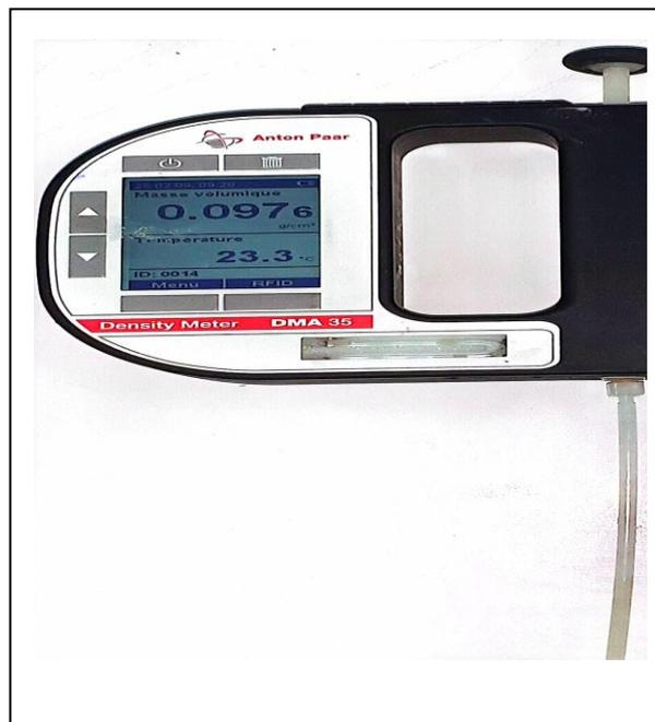
**Figure III.2:** Densimètre DMA35 BASIC V3 ANTON.
