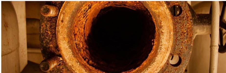
**Figure. III. 08 : Corrosion Galvanique**
