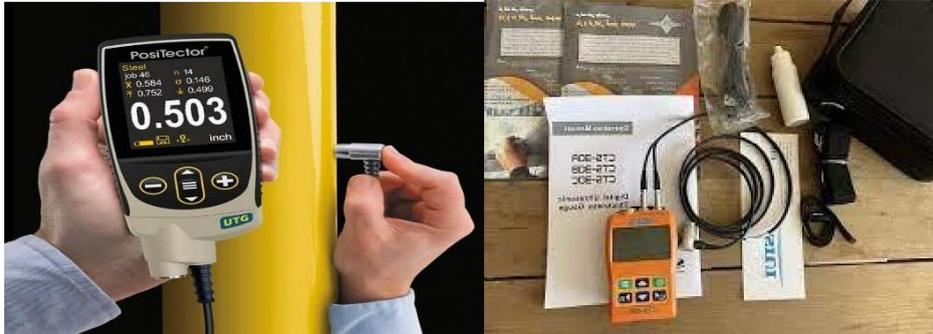
Figure. III. 03 : Prise d'essai ultrason
