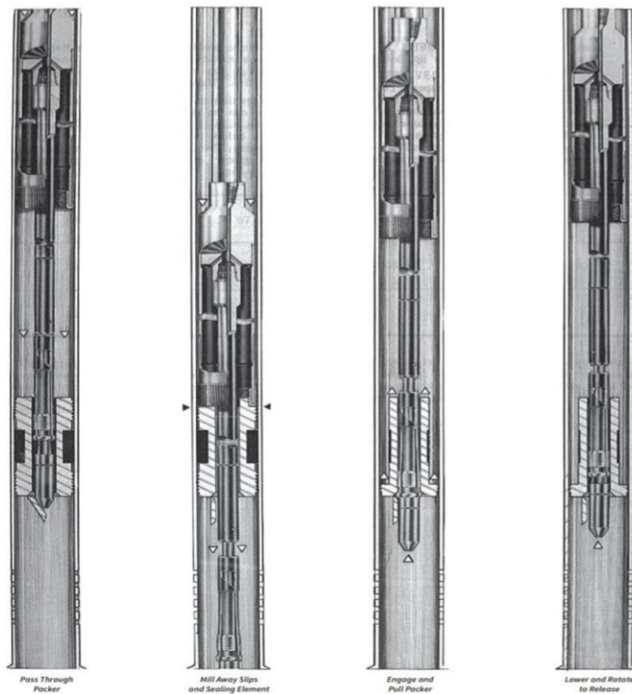
Fig. II. 11 :Schéma de procédure de fraisage de packer
