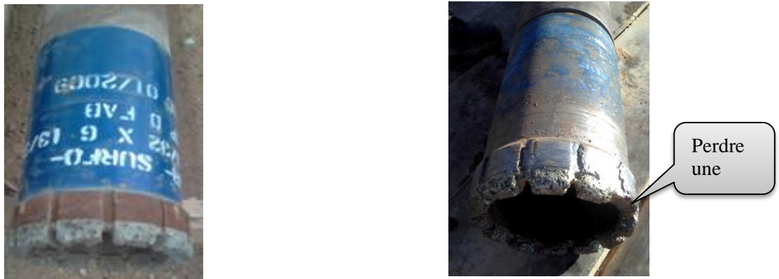
Fig III.7: La couronne 8''3/32 x 6''13/32 avant et après le fraisage
