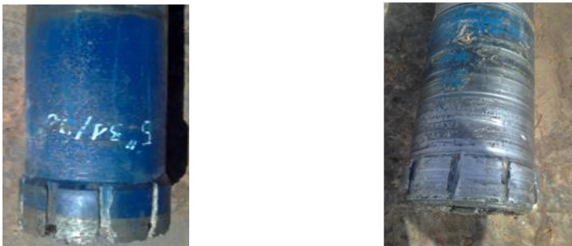
Fig III.10 : La couronne 5''31/32 x 4''3/8 avant et après le fraisage
