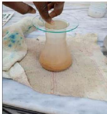
Photo II.2 : Essai de la masse volumique absolue.
