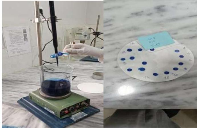
Photo II.4 : Essai de bleu méthylène
