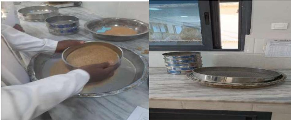
Photo II.6 Essai Analyse granulométrique
