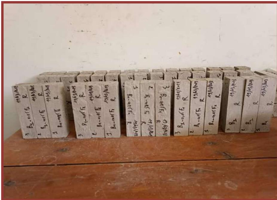
Photo A.2 : conservation des éprouvettes
