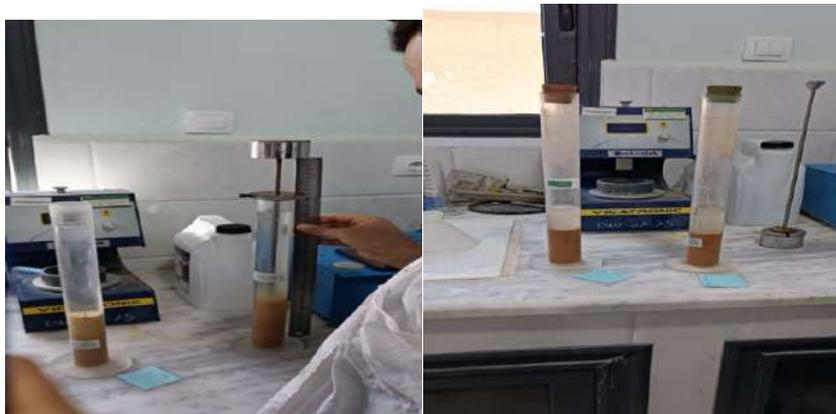
Photo II.3 : Essai d'équivalent de sable
