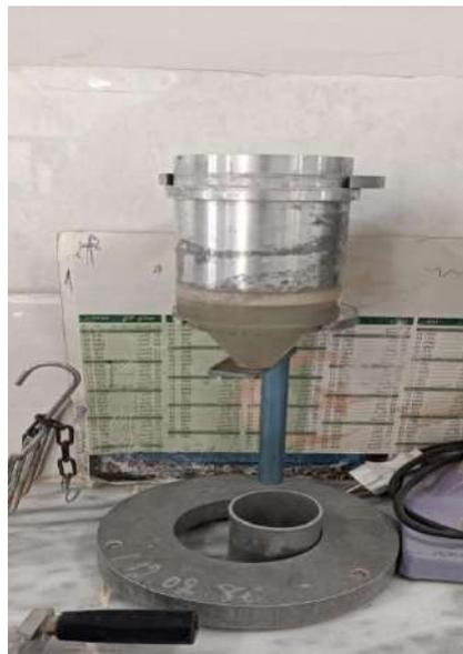
Photo II.2: Essai de la masse volumique apparente
