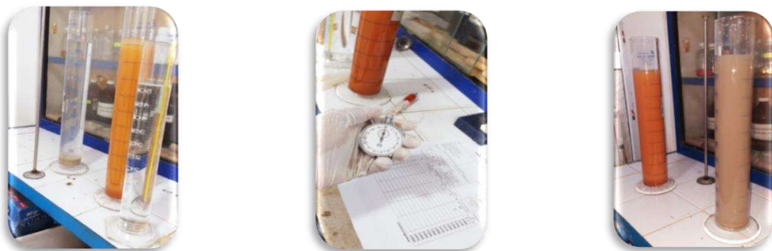
Figure II-15 : Opérateur d'essai de analyse granulométrique par sédimentation.
