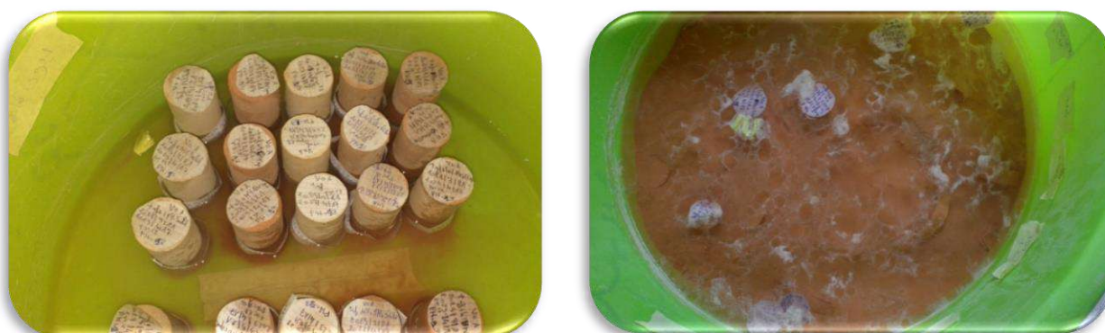
Figure III-13 : L'immersion des éprouvettes dans l'eau après 28 jour de conservation en mode1 et mode2.
