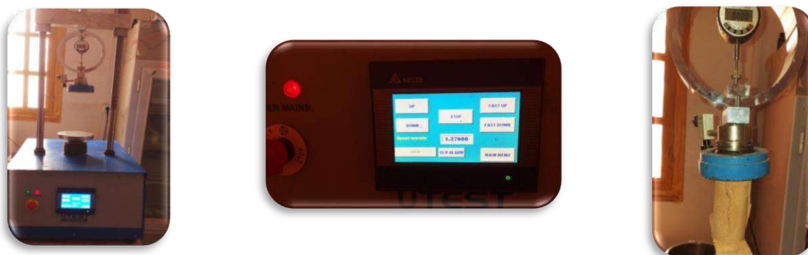
Figure III-1: Presse d'écrasement pour mesurer la résistance à la compression simple.
