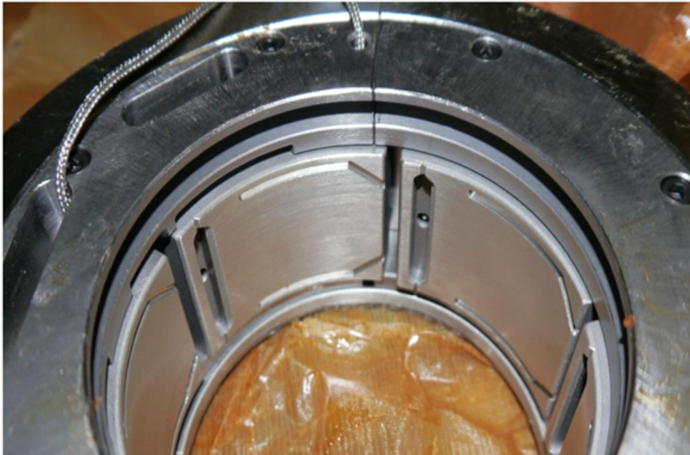
FIGURE V.2 – Palier lisse équipé de deux thermocouples pour la mesure de la température.
