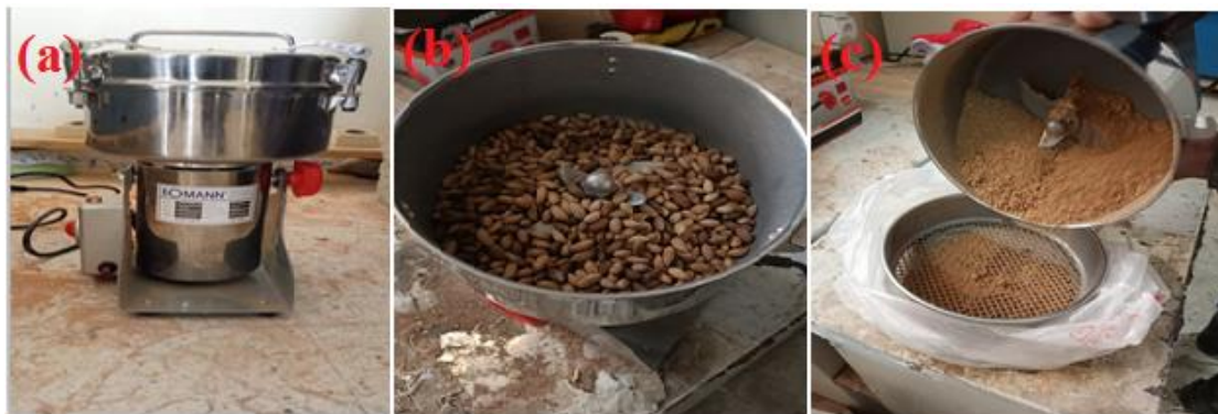
Figure II 3 : Mouture du noyau d'olive : a) broyeur de type BOMANN, b) réception de l'appareil et c) poudre de noyau
