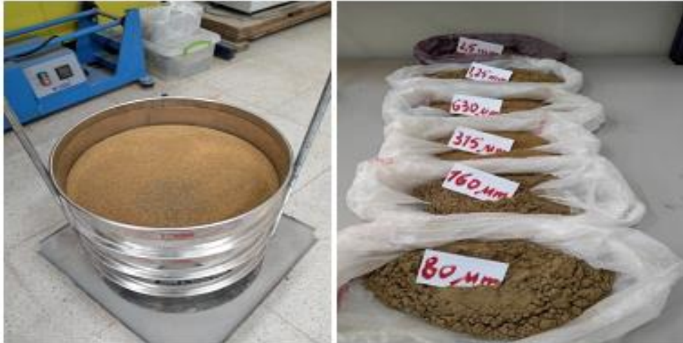
Figure III 1 : Test d'analyse granulométrique avec différentes dimensions des grains de noyau d'olive
