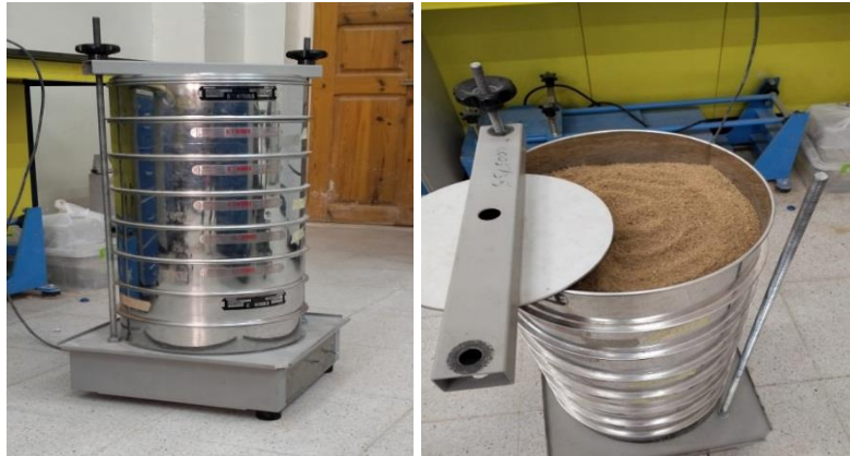
Figure II 6 : Test et les tamis l'analyse granulométrique.
