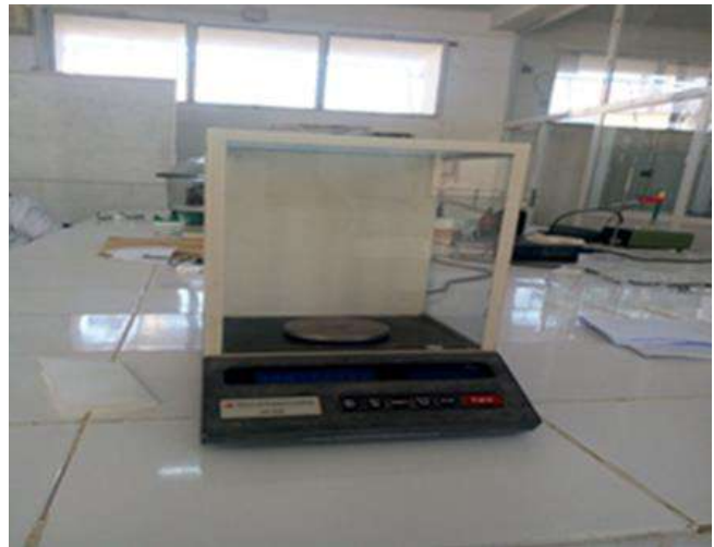
صورة للميزان الحساس المستعمل في القياسات
