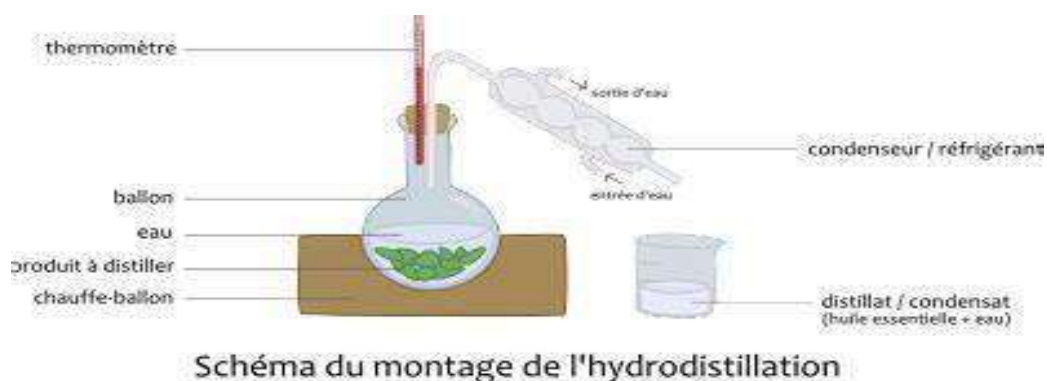
Figure 5: Schéma du montage de l'hydrodistillation
