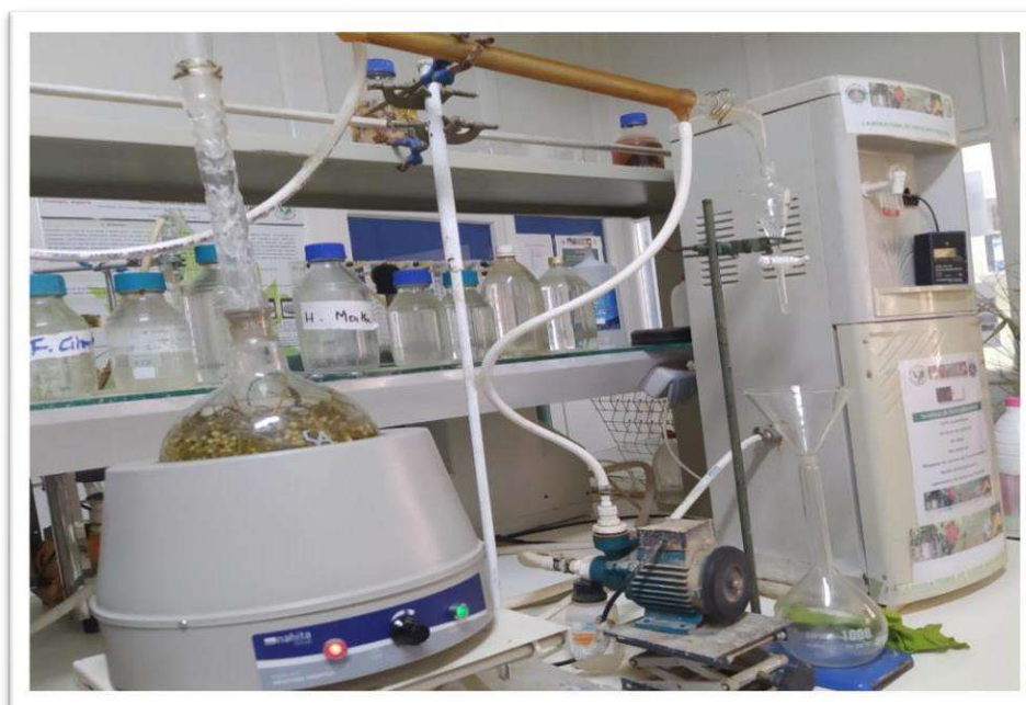
Fig.18 : Montage d'Hydrodistillation Utilisé lors de l'extraction
