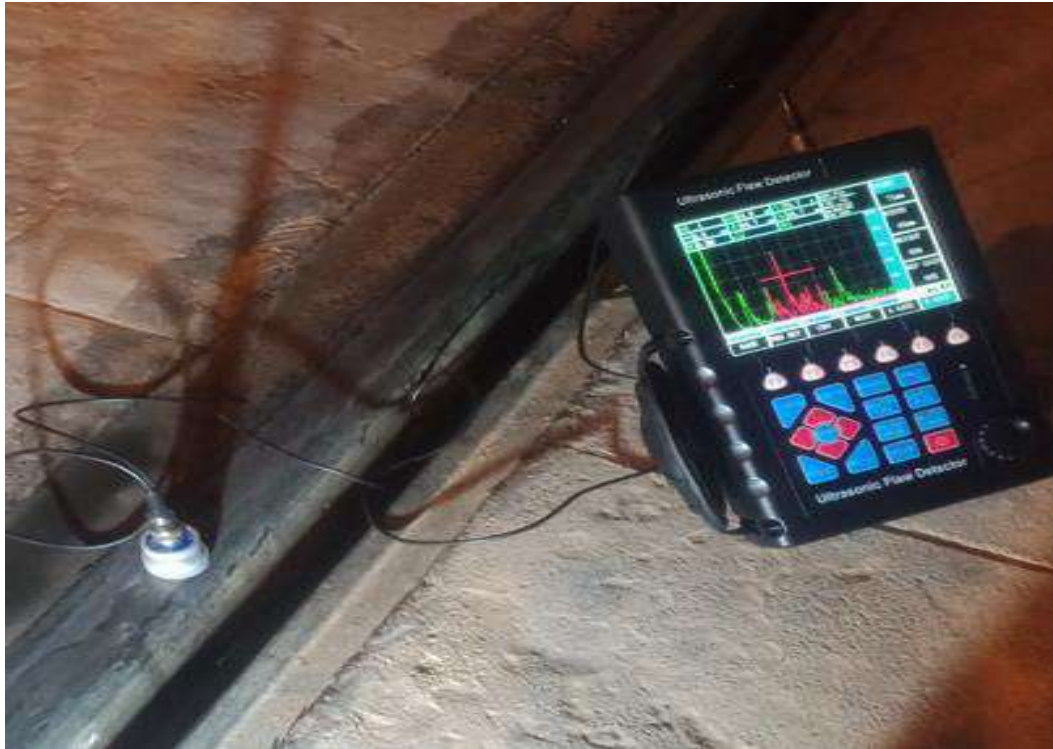
Figure III.9 : Détecteur des défauts internes type de JITAI9101.
