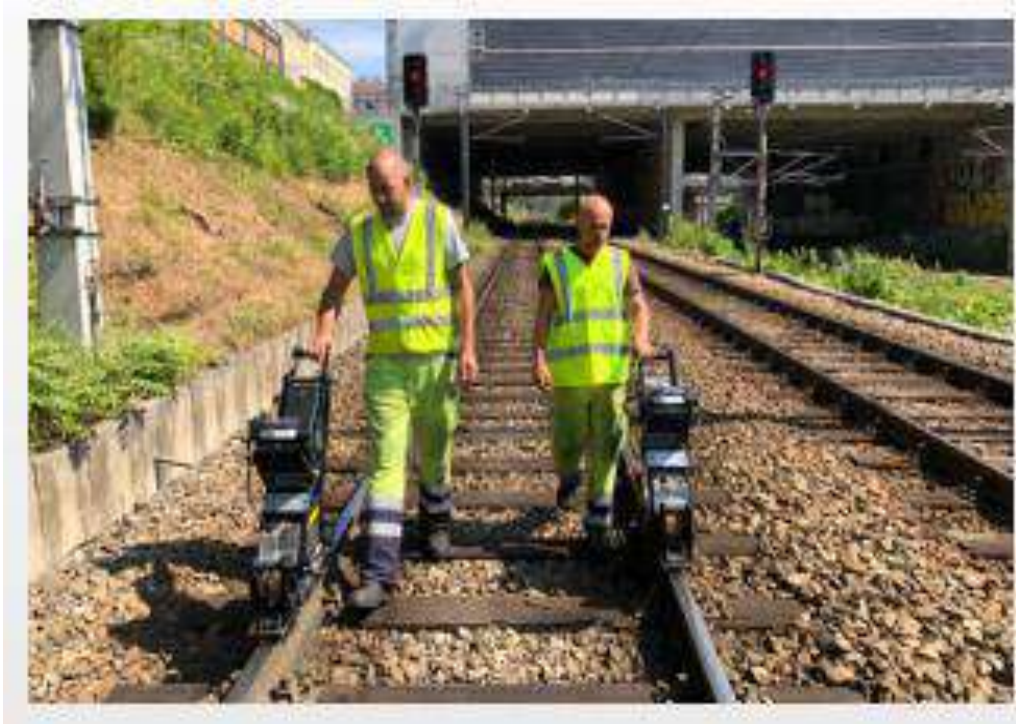
Figure II.9 : Technique de test par ultrasons [28].
