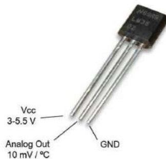
Figure II.6 Le capteur LM35
