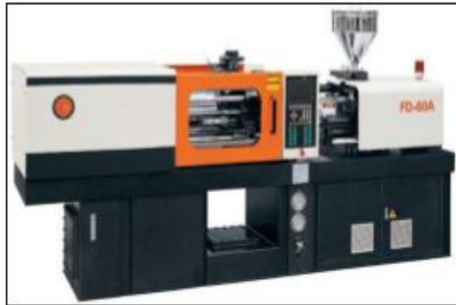
Figure I.2: Machine d'injection plastique moderne. [1]
