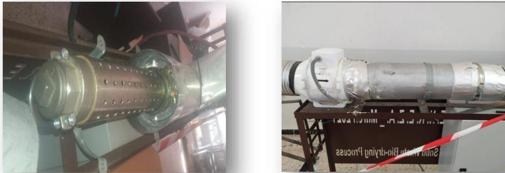
**Figure II.10:** Cylindre en acier inoxydable perforé (photo droite) & tube-calandre isolant rigide en fibre de verre (photo gauche).
