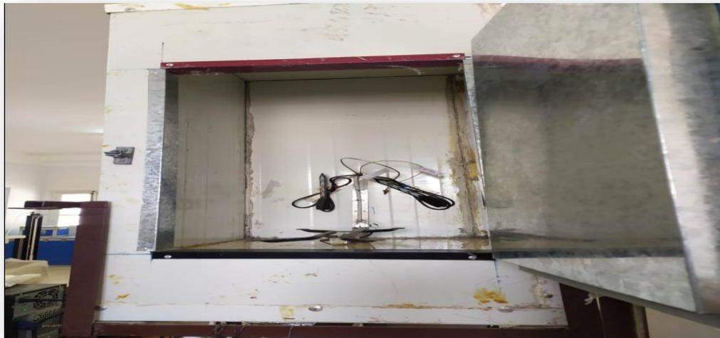
Figure II.4: Réacteur de bio séchage à isolation thermique
