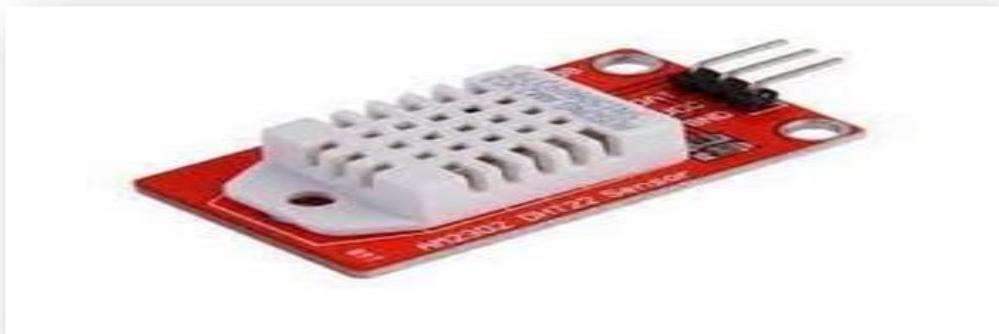
**Figure II.18:** Le capteur DHT22
