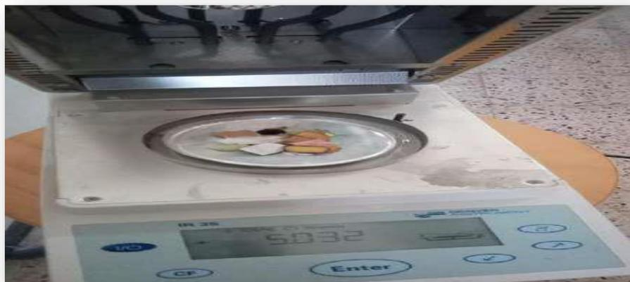
**Figure II.24:** Test d'humidité sur IR35 Denver Instrument.
