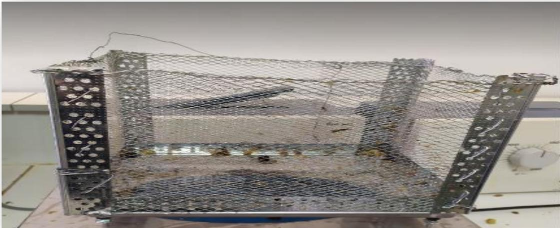
**Figure II.5 :** Support des déchets avec treillis métallique (trou de 5\*5 mm)
