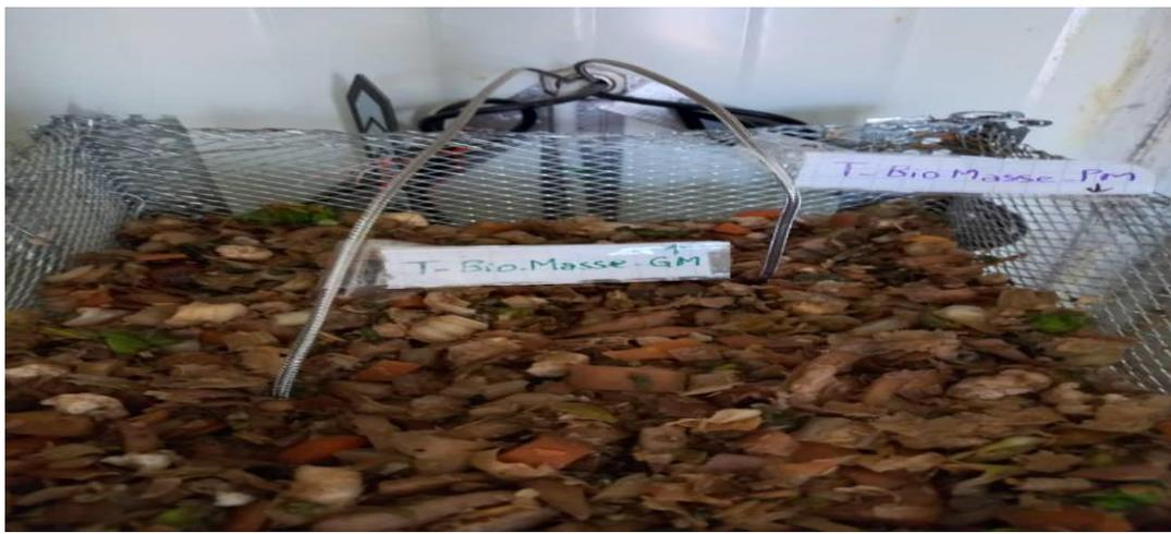
Figure II.31 : Introduction du mélange ds. le réacteur de bio séchage
