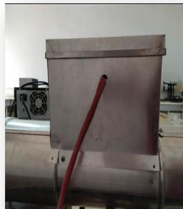
**Figure II.3:** Résistance chauffante 340 W
