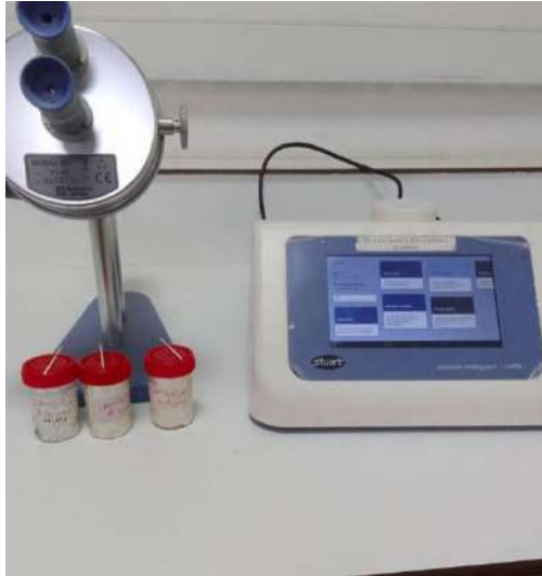
الشكل III.4: صورة تمثل جهاز الانصهار لمادة الاسيتامينوفين
