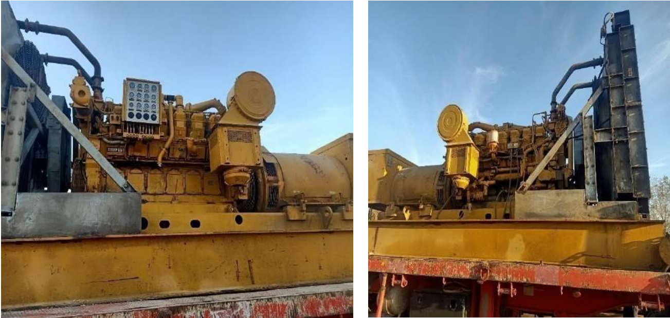
Figure II.24 : VU réel du moteur Caterpillar 3512
