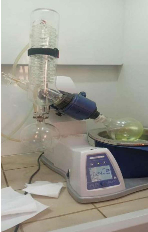
Appareil de rota de vapeur
