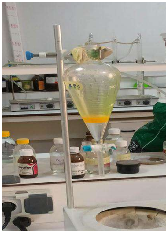
Figure 12 : Raffinat obtenu par extraction au Furfural.
