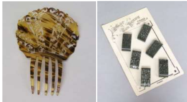
Figure II. 2 : (De gauche à droite) Epingle à cheveux 1920/1950 en celluloïd, Boutons 1920/1940 à base de caséine [30].
