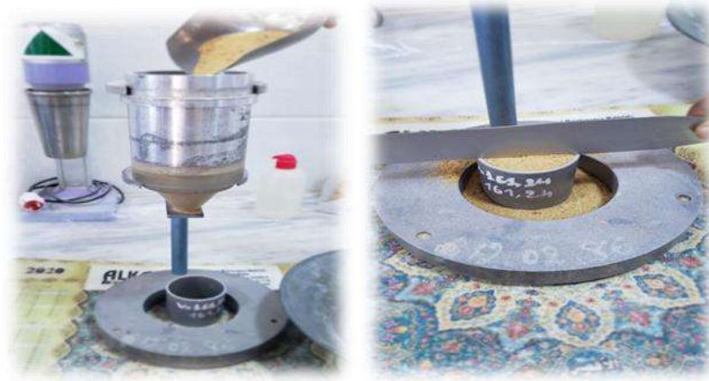
صورة II-5- تجربة الكتلة الحجمية الظاهرية
