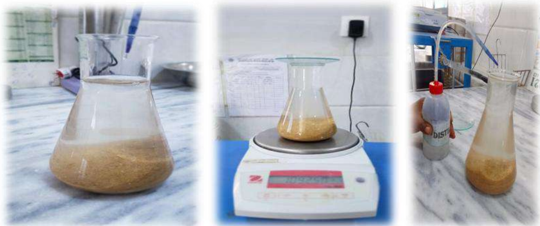
صورة II-6- تجربة الكتلة الحجمية المطلقة
