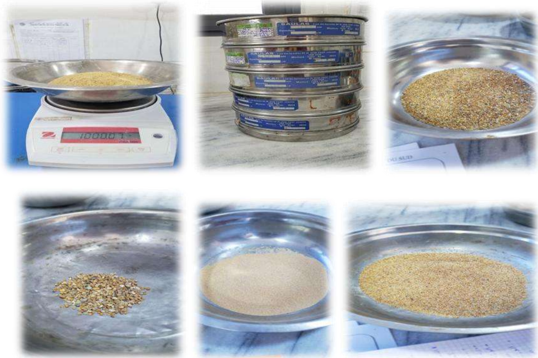
صورة-II-4- تجربة التحليل الحبيبي
