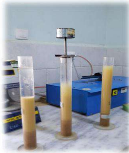
صورة II-2-1-2- تجربة المكافئ الرملي
