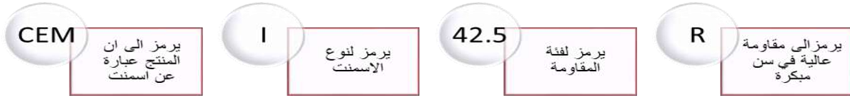
شكل-I-2معنى الاسم المختصر للإسمنت
