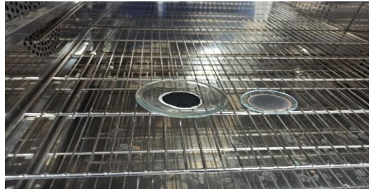
Figure III.17: Séchage de Filtre qui contient Les résidus .
