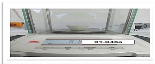
Figure III.9: Pesage de creuset en porcelaine après séchage .
