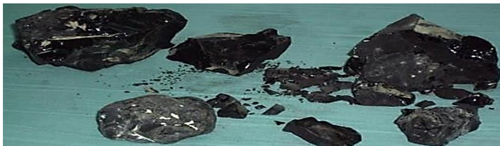
Figure II.3: des dépôts d'asphaltènes.
