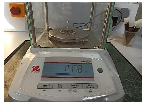
Figure III.20: Pesage de Filtre après deuxième séchage.
