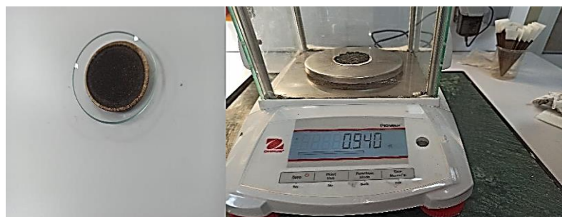
Figure III.18: Pesage de Filtre après Séchage.
