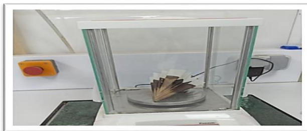
Figure III.25: Pesage de Filtre après Séchage.
