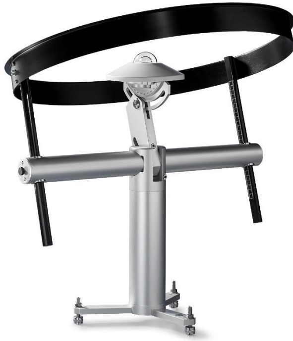
الشكل 3.2. جهاز البايرونومتر لقياس الإشعاع المبعثر [16]
