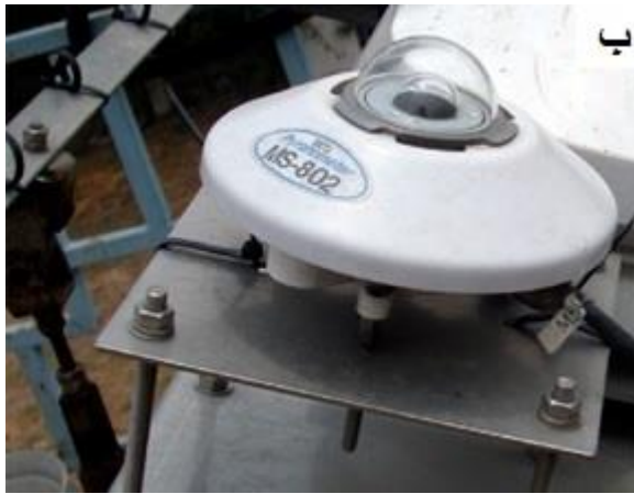
الشكل 1.2. جهاز البيرانومتر (أ) أفقي (ب) مائل [16]
