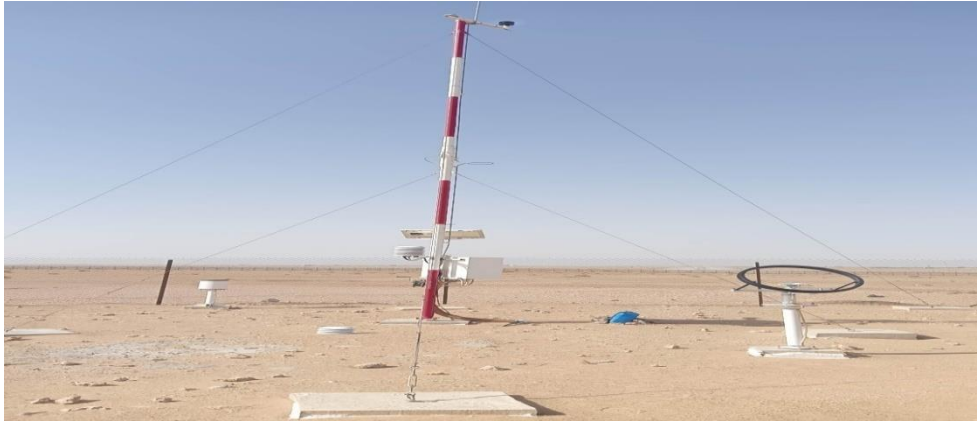
Figure IV.1 : la station automatique météorologique
