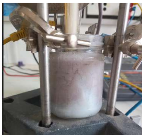
Figure II.5 : différentes phases de transformation physico-chimique de l'eau de drainage au cours du processus d'électrocoagulation.
