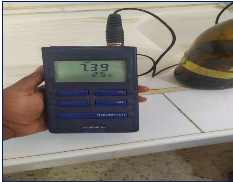
Figure III.7 : pH mètre type 3151
