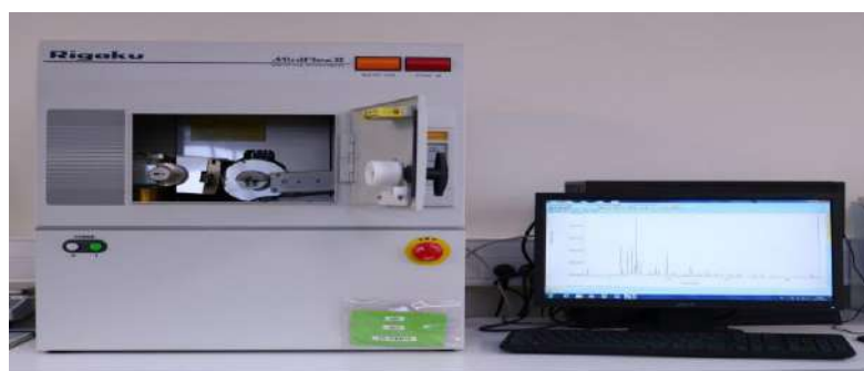
Figure II.5 : Photographies de (a) : Dispositif de diffraction des rayons X et (b) : Diffractomètre
