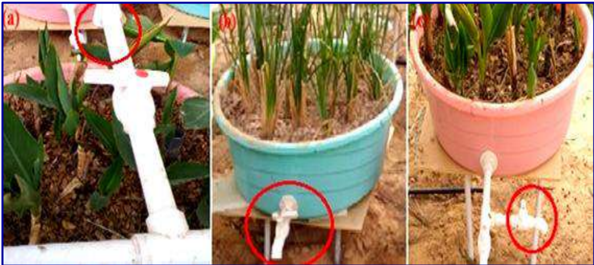
Figure III.19 | Prélèvement des échantillons : (a) Alimentation, (b) Vannes de prélèvements HFCWs et (c) Vannes de prélèvements VFCWs
