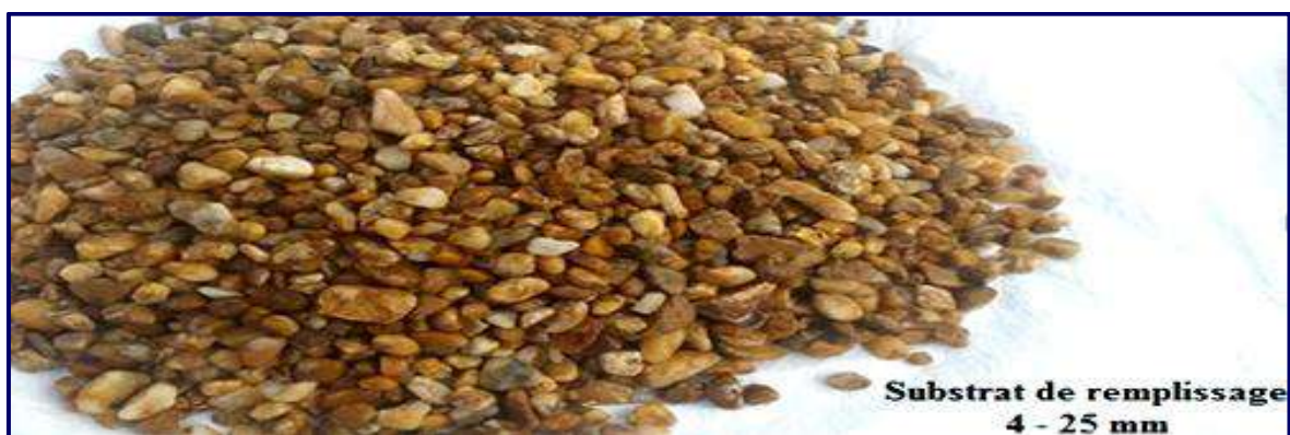
Figure III.11 | Support de remplissage des CWs
