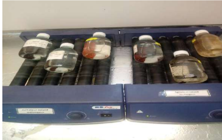
Figure 77. Expérience de l'effet désinfectant de l'eau avec les huiles adsorbantes sur support solide
