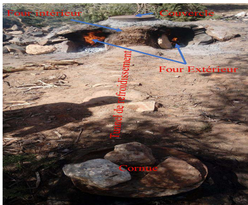
Figure 26. Technique d'extraction d'huile de cade par pyrogénéation (photo originale)
