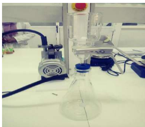
Fig 08. Appareil de filtration doté d'une pompe à vide
