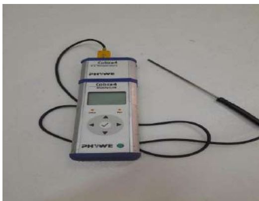
Fig 01. Thermocouple portatif, marque Cobra4 mobile-link
