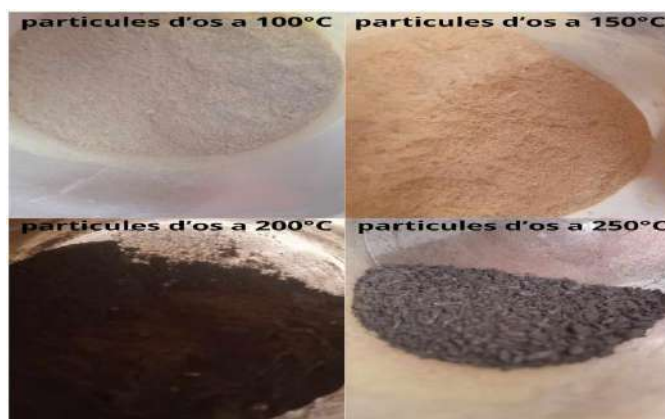
Figure 25.: Les adsorbants préparés à partir d'os bovin à des températures allant de 100°C à 250°C.
