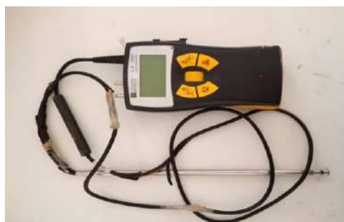
Figure II.7: Anémomètre à affichage numérique.
