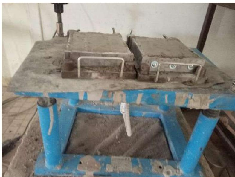
Figure (III.12): table de vibration
