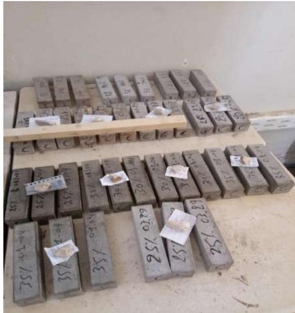
Figure (III.15): conservation des éprouvettes dans l'air libre.
