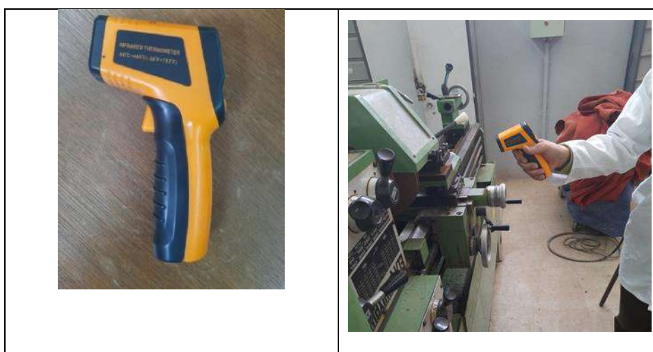
Figure II. 13: Thermomètre infrarouge de la marque UNI-T, UT 301 C
