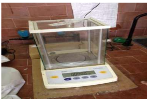
Figure II. 9 : Balance de précision numérique Sartorius
