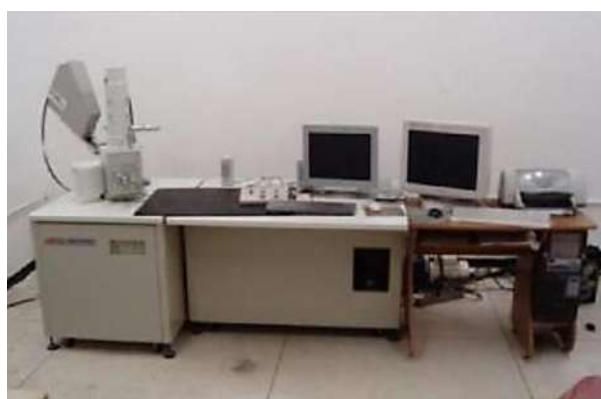
Figure II. 11 : microscopie électronique à balayage MEB 6360 couplé à l'EDS
