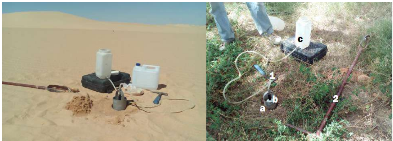
Photo III.1: Le perméamètre de Viguiier installé à l'Erg (à gauche) et à Sebkhia (à droite).
