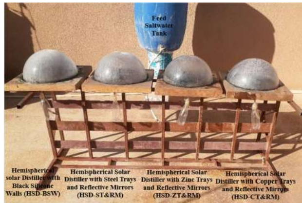
الشكل (I-4): صورة لمنصة الاختبار التجريبية HSD-BSW و HSD-Stand RM و HSD-CT [4].RM and
