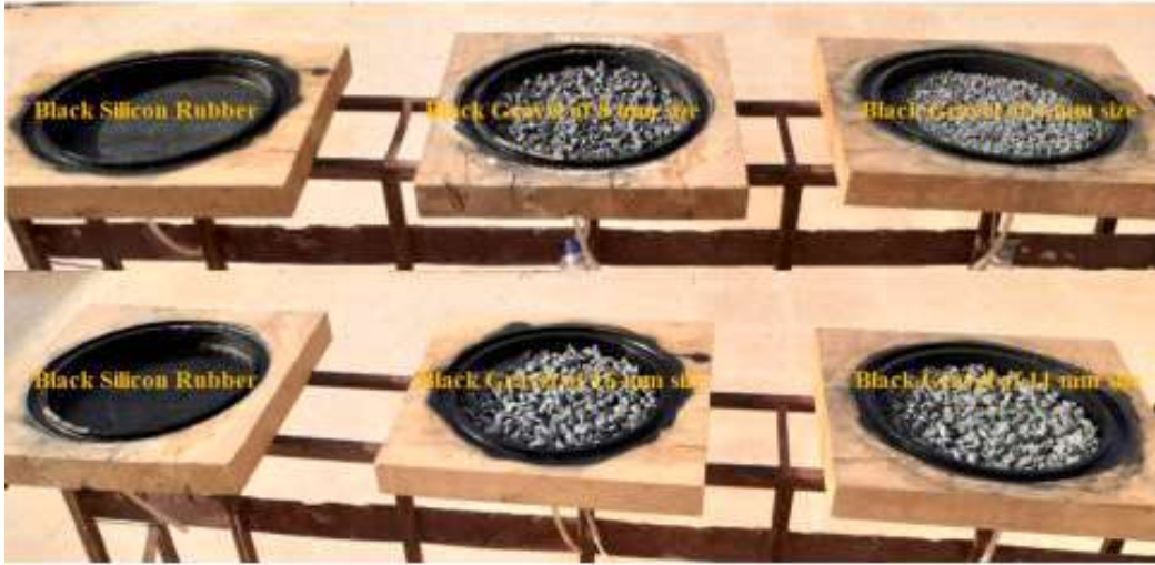
الشكل (I-9): منظر لحوض مقطرات نصف كروية بالحصى الأسود. [6]
