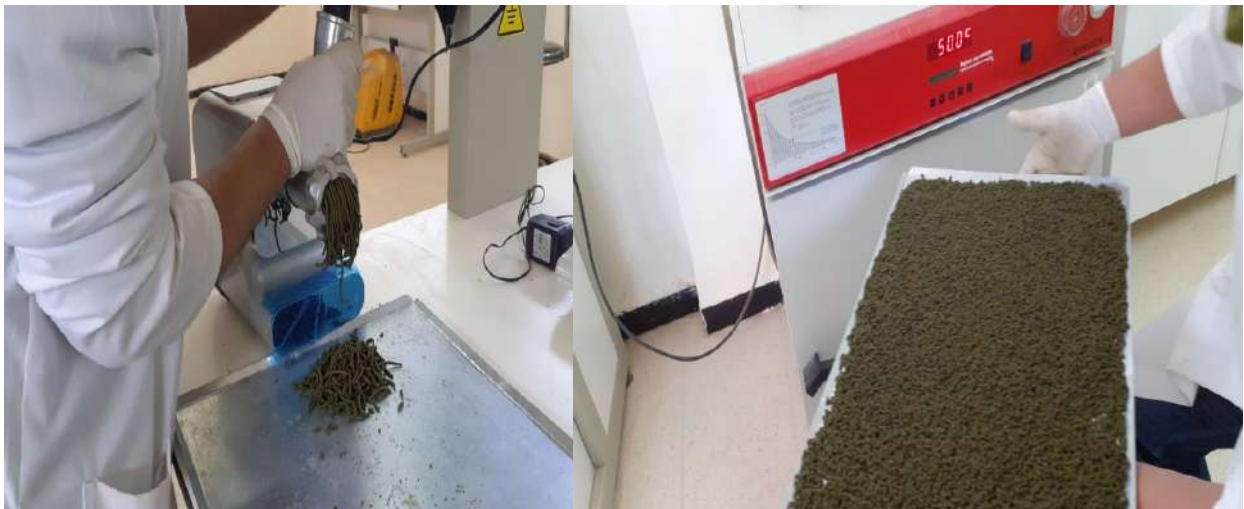
Figure 11. Utilisation d'un hachoir à viande pour faire des granulés de régimes alimentaires des poissons (Photo: Merah, 2020)
