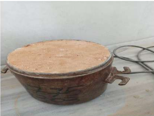
الشكل II.5: اجهزة المستعملة في اختبار بروكتور المعدل
