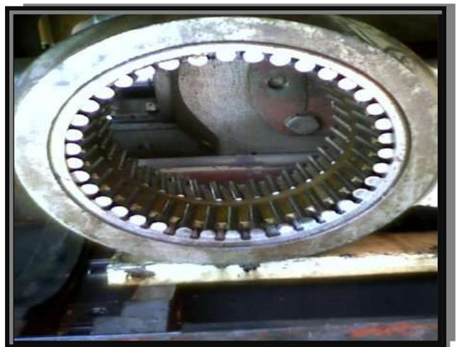
**Fig. 8 : Roulement de Bielle**
