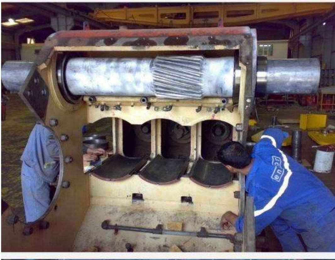
**IMG :structure de la pompe de forage**
