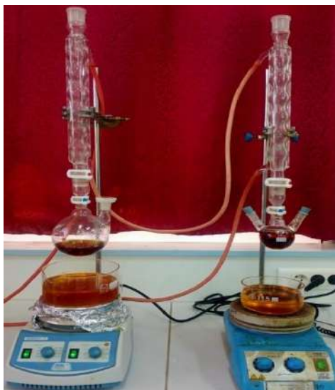
Figure II.4: Préparation de Mélange PVC Avec amine
