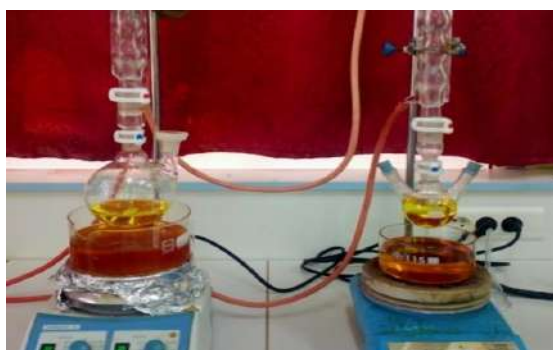
Figure II.3: Préparation de Mélange PVC Avec KI
