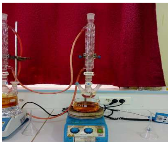
Figure II.2: Préparation de PVC Avec DMF
