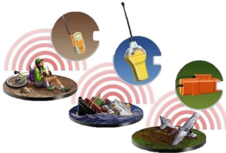
**Figure III.16. Les trois types balises de détresse 406 [16]**
