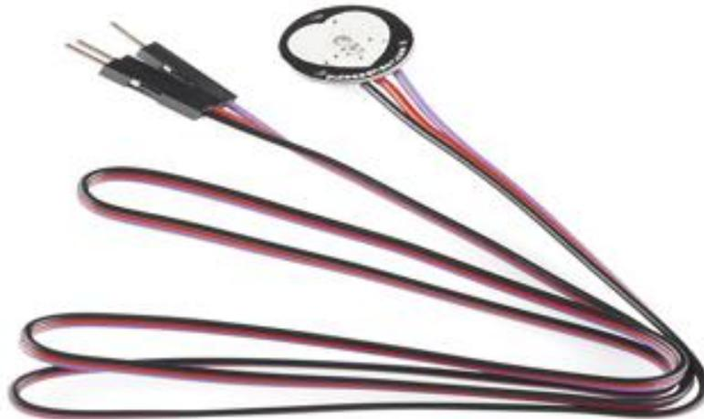
Figure IV.21. Capteur de fréquence cardiaque [21]
