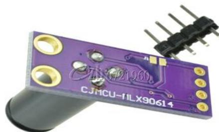
Figure IV.20. Thermomètre a capteur infrarouge [20]
