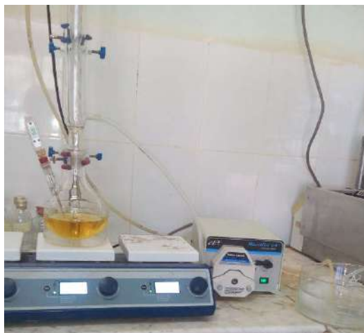
Photo 9: Photo de dispositif expérimentale de transestérification (STR)
