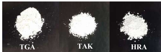
Photo 11: Photo des trois catalyseurs obtenus par calcination des noyaux de trois variétés de dattes (température de calcination 800°C)
