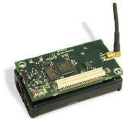
Figure 2: Example of capteur sans fil
