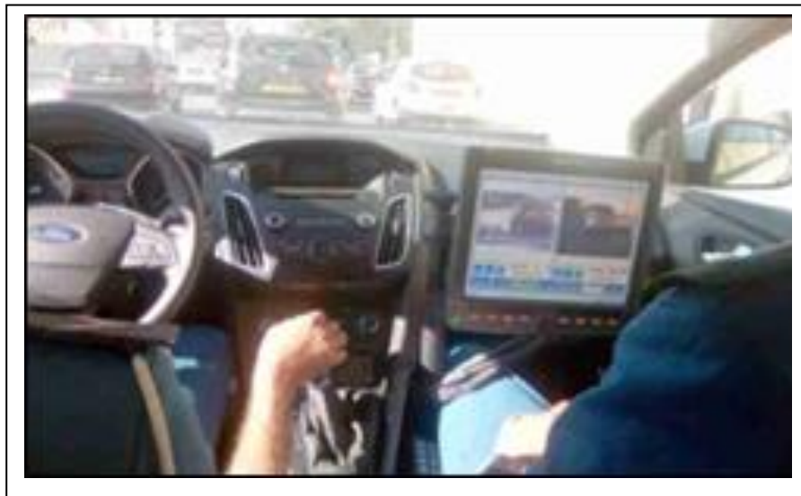
Figure I.12 : Lecteur automatique de plaques d'immatriculation.
