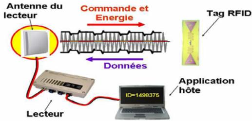
Fig. 1: Système UHF RFID [BEC, 2005]
