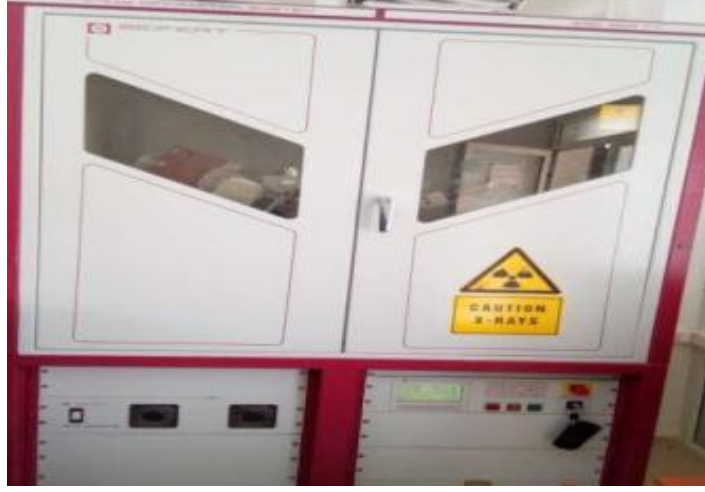
الشكل(II.8): يمثل انعراج الأشعة السينية DRX [32]
