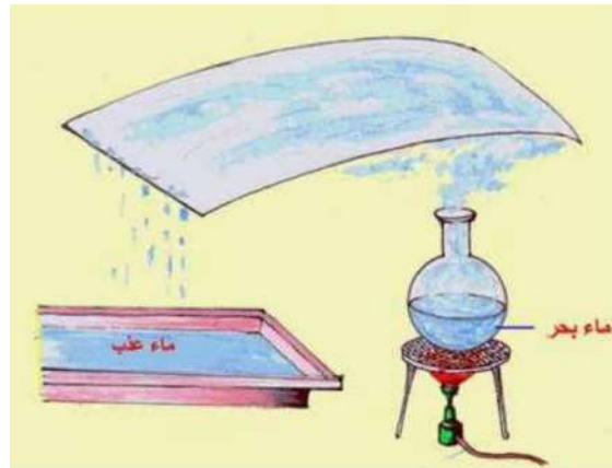
الشكل (4-1) طريقة بدائية لإعذاب ماء البحر بالتقطير [20] الشكل (5-1) التقطير الشمسي [21]
