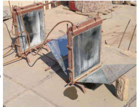
الشكل (6-2) صورة فوتوغرافية للمقطر الشمسي العمودي [2] الشكل (7-2) مخطط يوضح مقطع جانبي للمقطر الشمسي
